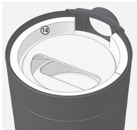
Obr. 3.12 Na poslední akumulární vložku – nástavec se zadním připojením – umístěte těsnění z vláknitého rouna
