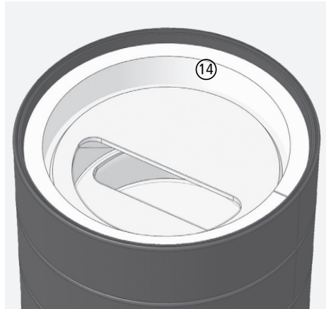
Obr. 3.11 Na poslední akumulární vložku – nástavec s horním připojením – umístěte těsnění z vláknitého rouna
